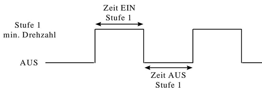
Bei Zeit ON laufen die Ventilatoren von Stufe 1 mit der eingegebenen min. Drehzahl. Die Signallampe der Stufe 1 blinkt. Bei Zeit OFF laufen die Ventilatoren der Stufe 1 nicht. Die Signallampe der Stufe 1 erlischt. Stufe 1 Mindestgeschwindigkeit kann auch durch eine Geschwindigkeitskurve definiert werden.
